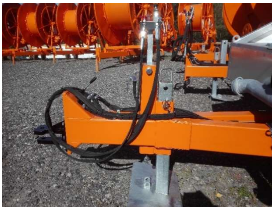
Hydraulische Fallstütze (Hydraulikzylinder für Verladung eingefahren)
