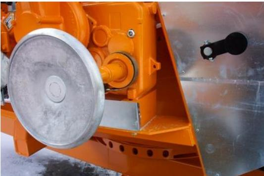
Das mitgelieferte Handrad auf Zapfwellenstummel setzen und drehen, bis die Trommelsperrklinke, auch Rücklaufsperrklinke, durch Umlegen entriegelt werden kann.
