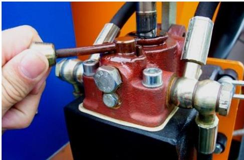
Nach erfolgtem PE-Rohreinzug die Stützen und das Stativ durch die Handpumpe oder Steuerventile hochheben (Hydraulikabsperrhahn öffnen).
