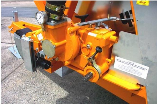
Der Kompaktantrieb umfasst ein 4-Ganggetriebe mit Ein-Ausschaltung sowie Zapfwellenschnellspulung, eine integrierte Turbine und eine Bypass Geschwindigkeitsregelung. Die Abdichtung der Turbine besteht aus einer Gleitringdichtung auf rostfreier Welle.
