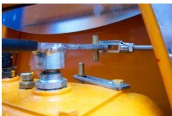
Am Ende des Beregnungsvorganges wird der Rohreinzug über das Abschaltgestänge automatisch gestoppt. Die Wasserzufuhr wird dadurch nicht abgeschaltet. Wenn am Computer ein Über- oder Unterdrucksystem aktiviert ist wird die Wasserzufuhr unterbrochen (Totalabschaltung).
