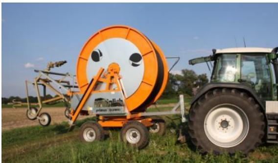
Mit Hilfe der hydraulischen Höhenverstellung der Zugmaulanhängung die Maschine vorne ca. 10 – 15 cm höher anhängen, damit die vordere Achse entlastet wird und die Räder beim Kurven fahren nicht radieren.
