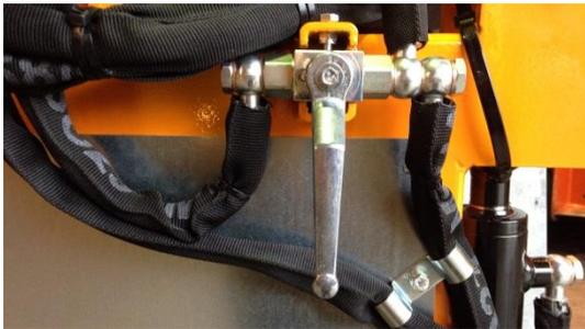
Wenn die Maschine richtig abgestützt ist den Hydraulikabsperrhahn schließen.
