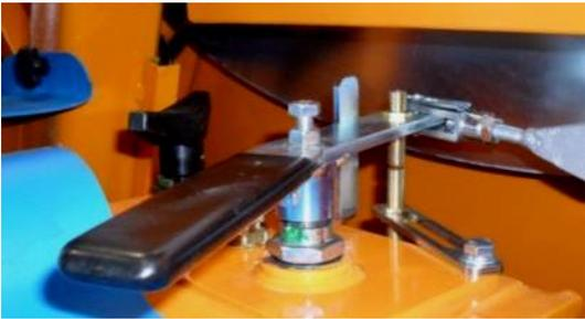
Wenn der Arbeitsdruck erreicht ist und bei der Regnerkanone Wasser im geschlossenen Strahl austritt, den Schalthebel des Getriebes in Stellung „EIN“ stellen.
