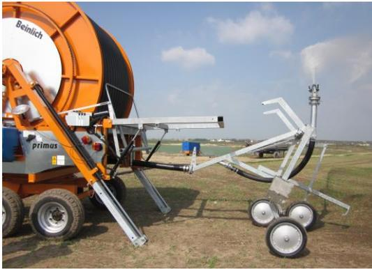
Stativhebevorrichtung so stellen, dass eine einwandfreie Aufnahme der Stativfangarme bei Betonungsende gewährleistet ist.
