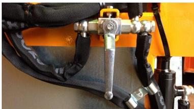
Nach dem Anheben der Stativhebevorrichtung den Hydraulikabsperrhahn wieder schließen.
