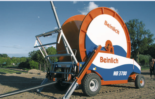
Perfekte Standfestigkeit im Einsatz und sichere Straßenlage beim Transport durch tief liegenden Schwerpunkt und Rohrzug. Perfect stability in the field and safety transportation due to the low lying reel and pull-in of pe-hose.
