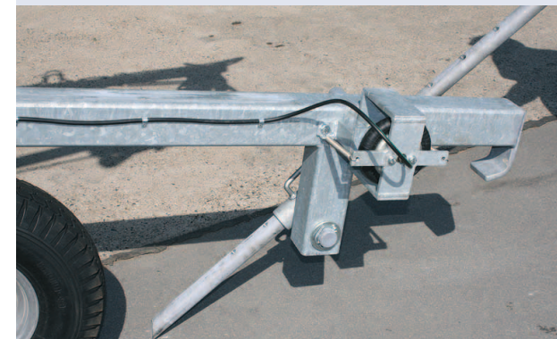
Automatischer Bodenanker Automat. anchor system
