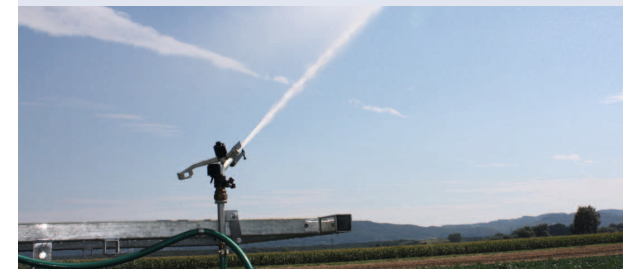
Regner K1 8° für 15 m Wurfweite, horizontal montiert auf der Hebevorrichtung Sprinkler K1 8° with 15 m throw, horizontally mounted on lift frame
