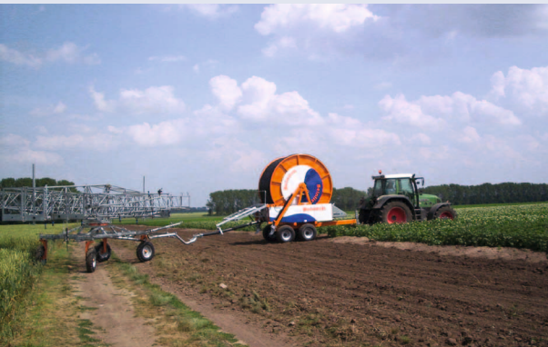
Dank 4-Radlenkung läuft der Düsenwagen exakt in der Traktorspur nach Because of the 4-wheel steering system, the boom follows exactly the track of the tractor
