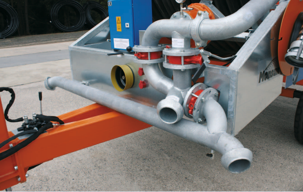
Abschaltklappe, Regelklappe, mech. Abschaltklappe und beidseitige Wassereinspeisung
