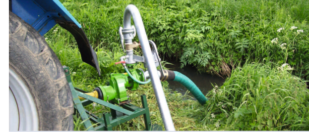
Traktorpumpe von Rovatti im Einsatz Tractor pump from Rovatti in use
