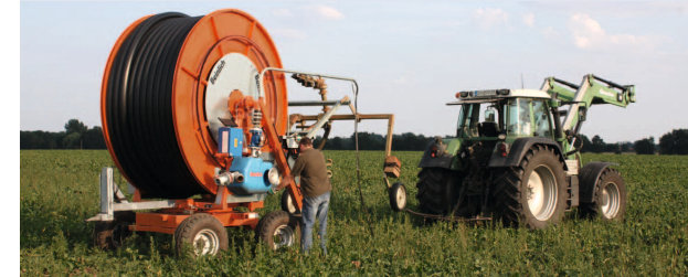
Nach 180°-Schwenk der Trommel zieht der Traktor das Rohr aus After rotating the drum by 180°, the hose can be pulled out by the tractor
