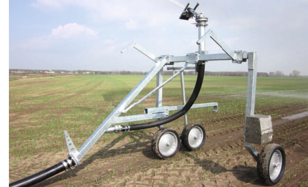
Torbogenstativ im Einsatz Type 80 mm offset water-feed
