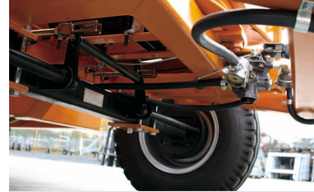
Vordere Achse mit Jost Drehkranz, 45° lenkbar Steering front axle on a turntable, in a 45° angle
