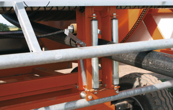
Der 3-teilige Spulwagen und die zusätzliche Führungsschiene garantieren einen verschleißarmen Einsatz bei hohen Belastungen.
