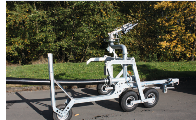
Vorderrad lenkbar inkl. Abschaltgabel steering front wheel in combination with shut-off pin
