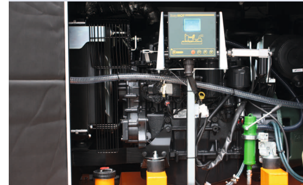
Die digitale Motorsteuerung „Idromop“ regelt automatisch die Motordrehzahl und sorgt für konstanten Arbeitsdruck
