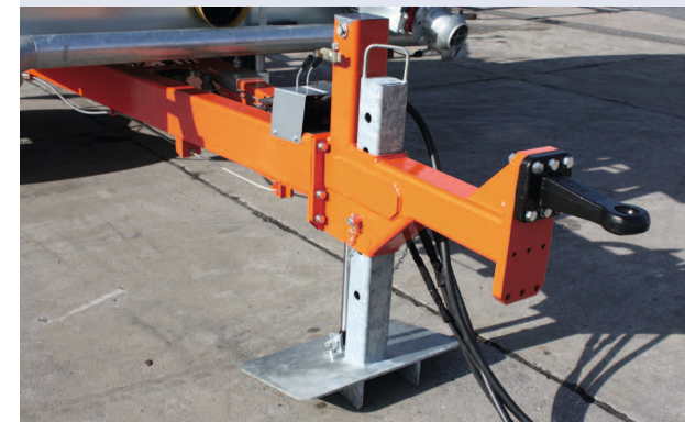
Zugöse mit hydr. Stütze inkl. Verlängerung des Fahrwerks
