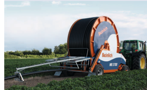
Rohrausleger mit hydraulischer Seiten- und Höhenverstellung Guiding arm is adjustable hydraulically in all directions
