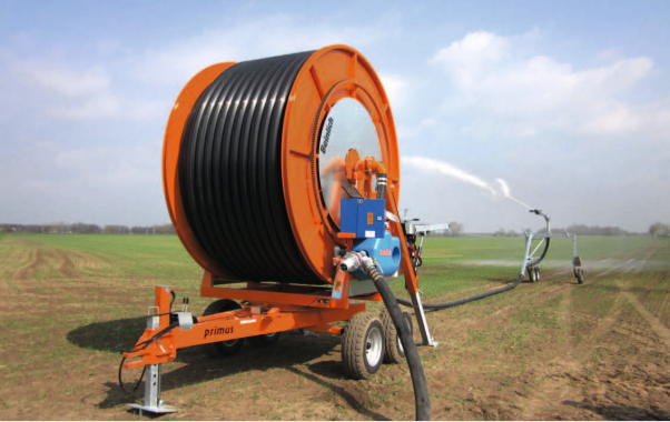
Bodenfreiheit 500 mm, Spurweite 1.8 m - 2.0 m oder 2.0 m - 2.25 m
