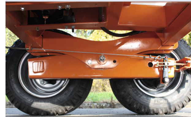
Pendelachse mit Druckluftbremse an 2 Rädern Swing axle with air-brakes on 2 wheels
