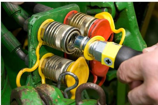
Hydraulikschläuche am Traktor anschließen.
