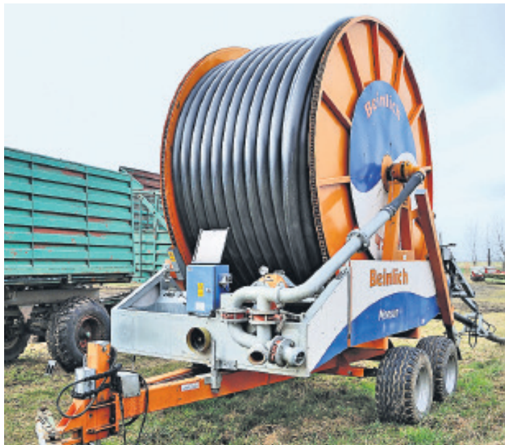
Auf der Trommel des Regners befinden sich 600 m PE-Rohr, durch die das Wasser strömt. Beim Aufwickeln des Rohres wird der Düsenwagen über das Feld gezogen.
