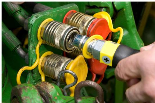
Hydraulikschläuche am Traktor anschließen.
