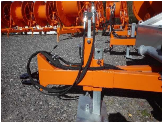
Hydraulische Fallstütze (Hydraulikzylinder für Verladung eingefahren)
