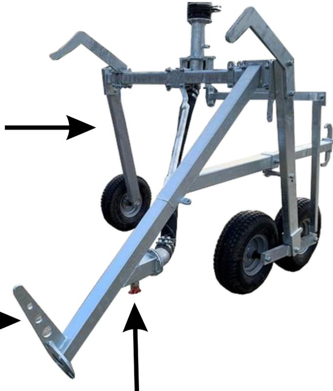
Ein 1" Kugelhahn dient zur Entleerung oder als Anschluss für einen Kompressor.
