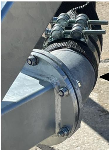
Der Flachslauch ist nach oben mit einem 45° Bogen und nach unten mit einem 30° Bogen angeschlossen. Das verhindert ein Abknicken
