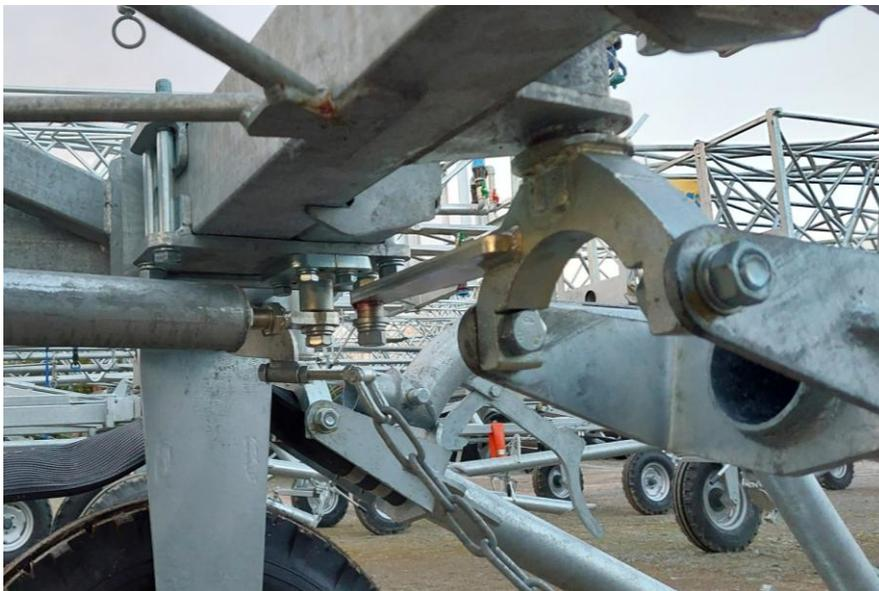
7. Befestigen Sie die Verriegelung der Zugösen am gleichen Ende wie der Bausatz. (Dies soll verhindern, dass jemand versucht, den Ausleger vom festen Ende aus zu fahren.)
